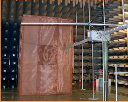
EMC-Messung eines mit Cuprotect® Spezial doppelagig abgeschirmten Würfels bei EMC-Test NRW unter Praxisbedingungen.
