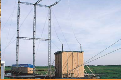
Freifeldversuch mit Hochspannungsimpulsen: Die beiden Kuben sind mit zweilagigem Cuprotect® Spezial abgeschirmt.
