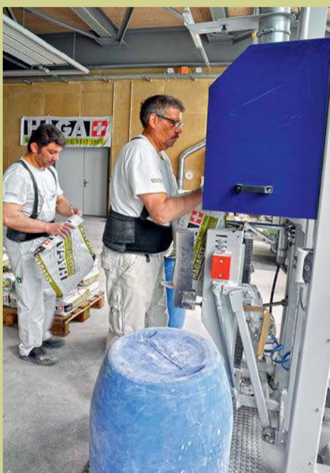
1 und 2: Die Rohstoffe werden genau abgewogen und in die Mischanlage gegeben. 3: Die neue Mischanlage verarbeitet viel grössere Volumen als ihre Vorgängeranlage. 4: Nichts für Zartbesaitete: Ein Sack erreicht ein Abfüllgewicht von 9 bis 40 kg.
