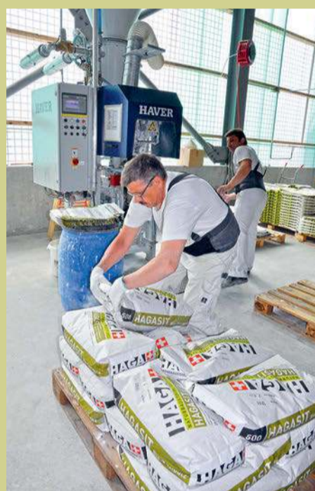
1 und 2: Die Rohstoffe werden genau abgewogen und in die Mischanlage gegeben. 3: Die neue Mischanlage verarbeitet viel grössere Volumen als ihre Vorgängeranlage. 4: Nichts für Zartbesaitete: Ein Sack erreicht ein Abfüllgewicht von 9 bis 40 kg.
