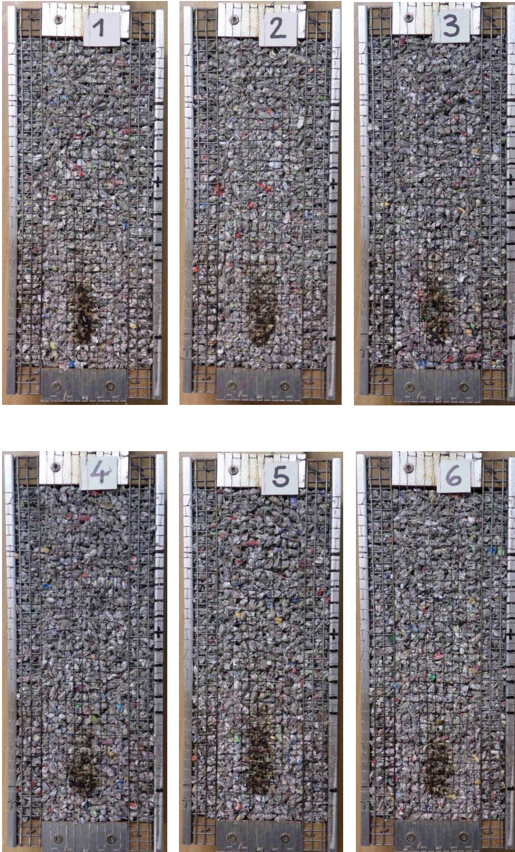
Abbildung 1 Brandverhalten nach EN ISO 11925-2: Proben nach der Prüfung
