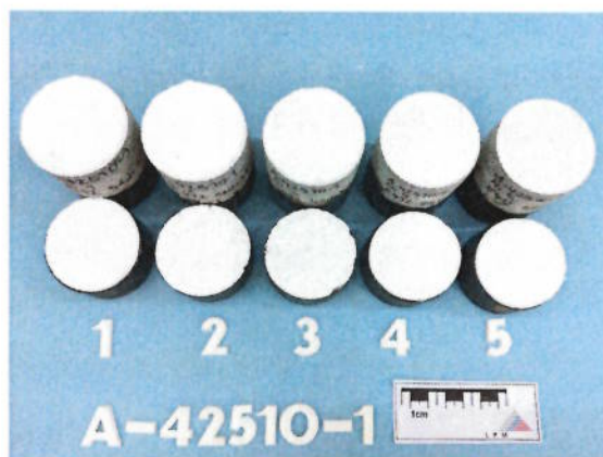
Foto 2: Bruchbilder nach Abreissprüfung - 56 Tage
