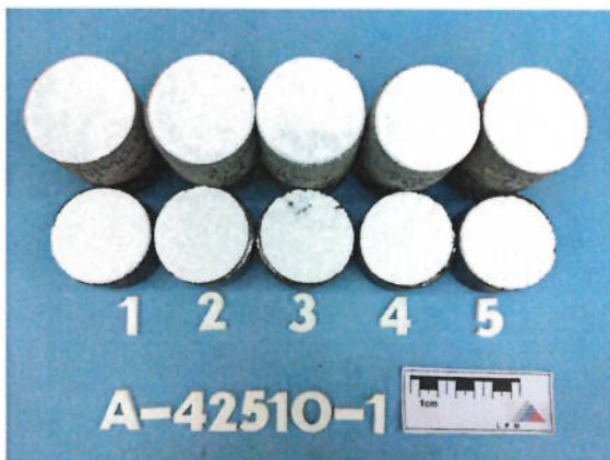
Foto 1: Bruchbilder nach Abreissprüfung - 28 Tage
