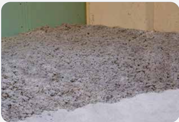
THERMOFLOC-Fussbodenschüttung als nicht druckbelastbare Zellulosedämmung
