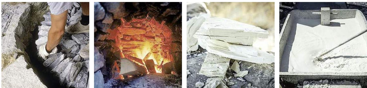
Das Urmaterial Sumpfkalk ist Ausgangsprodukt von HAGA Calkosit Kalkfeinputz.
